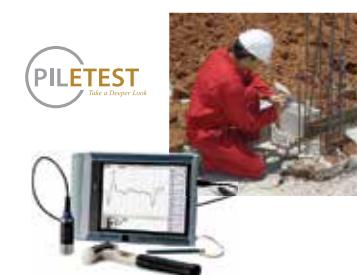
TESTIRANJE BETONSKIH PILOTOV
