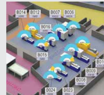
Digitalni dvojček strojnega parka s prikazom trenutnega delovanja (OEE, stanje oz. morebitni zastoji, trenutni števec, čas do konca).
